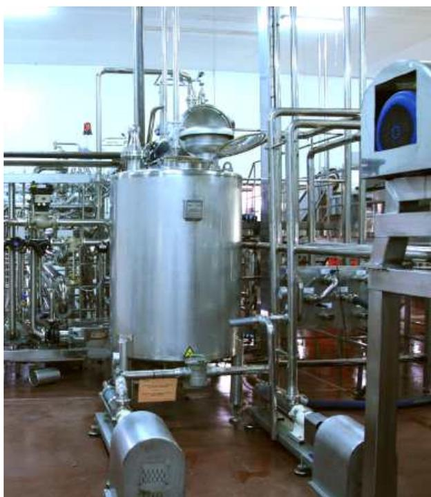
Dans le **processus à chaud**, les turbo extracteurs sont alimentés par de la vapeur, de manière à ce que soit créée une atmosphère inerte qui puisse déplacer l'air contenu à l'intérieur de la machine et éviter que le produit s'oxyde.
